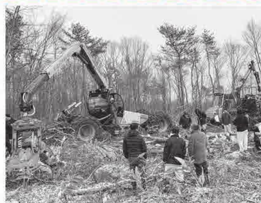
急斜面での作業もでき生産効率が飛躍的に向上する次世代型ハーベスタ(ハイランダー)と8輪駆動フォワーダ(グレモ)
