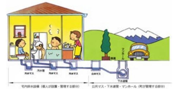
個人管理の宅内排水設備のマス蓋や排水管が破損すると雨水や土砂が入り、詰まりや悪臭の発生、さらには汚水処理場の故障につながります。
